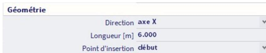
**Poteau :** avec cette option, vous pouvez dessiner un élément vertical 1D par un point, une longueur et un point d’insertion. Cet élément a automatiquement le type « Poteau(100) ».
