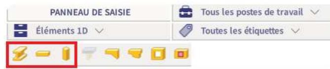
**Barre :** avec cette option, vous pouvez dessiner un élément 1D par deux points. Cet élément a automatiquement le type « General(0) » ou « Poutre(80) ». Vous pouvez modifier la forme de l’élément avec la barre d’outils ci-après (elle apparait en-dessous de SCIA SpotLight lorsque vous modélisez l’élément).
