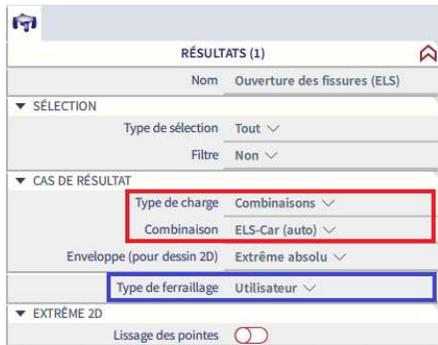
→ Combinaison utilisée pour effectuer la vérification de l'ouverture de fissures.
