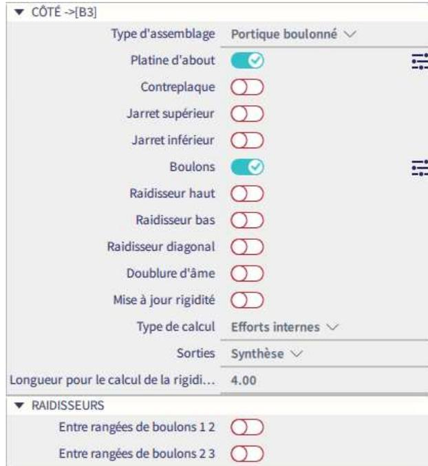
Pour créer l'attache, choisir le « Type d'assemblage » et vérifier les composants de l'attache. Pour éditer les composants, cliquer sur les trois petits points en face du nom du composant.
