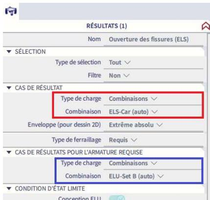
→ Combinaison utilisée pour effectuer la vérification de l'ouverture de fissures.
